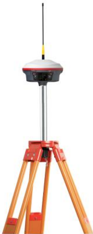
(图 3.3 内置电台 1+1 模式基站架设)
