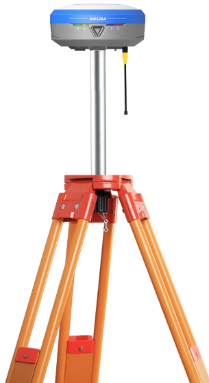
(图 3.3 内置电台 1+1 模式基站架设)
