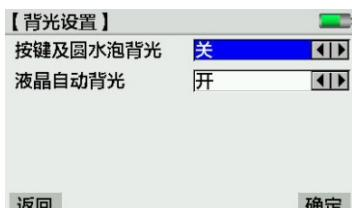
背光设置包括：按键及圆水泡背光、液晶自动背光、液晶背光亮度设置。
