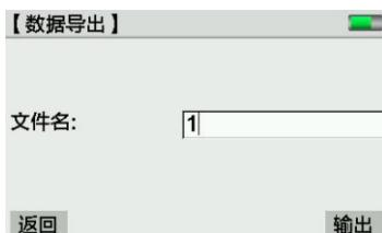
输入蓝牙文件的文件名，点击“输出”即开始输出作业中的线路到蓝牙设备。
