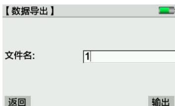
输入蓝牙文件的文件名，点击“输出”即开始输出相应的线路到蓝牙设备，导出成功后会在蓝牙设备端接收到该线路文件。
