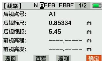
显示键是对一个已给状态的附加“软件键”，显示键可用导航键标记，当光标移到按钮时，按压【ENT】就启动相应功能。
