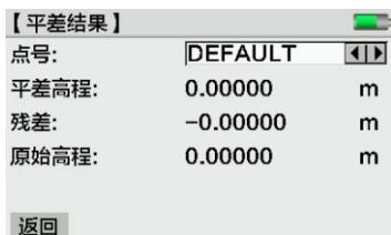
点号列表框获得焦点时，利用导航键【←→】移动查看所有的平差点。
