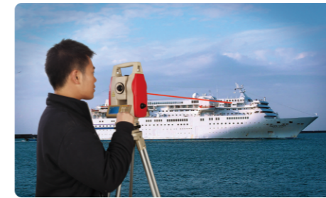
免棱镜全站仪用于大型船舶制造的测量与定位。
