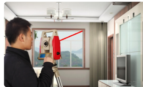
免棱镜全站仪用于房产测量，特别是不规则大型房屋的测量。
