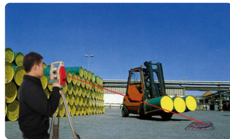
在实际测量中90%以上的点在300米以内，免棱镜全站仪能解决大部分问题。
