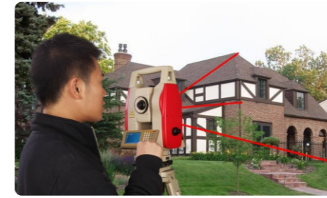
免棱镜全站仪用于大型框架的测量和放样。
