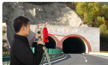
免棱镜全站仪用于隧道测量、采煤掘进、机库建设，可免去支架棱镜的工作，又快又准。
