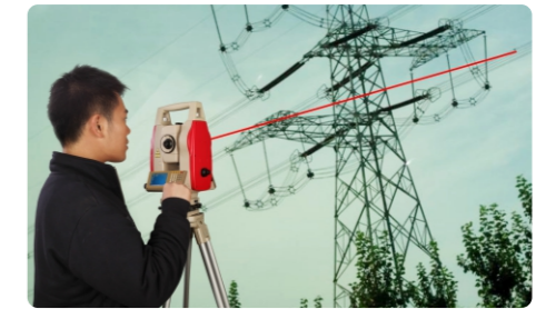
免棱镜全站仪用于电力线测量和电力线路放样。
