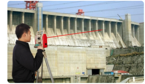
免棱镜全站仪可用于大坝等大型建筑物的变形监测。
