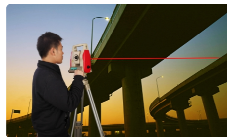
有了免棱镜全站仪，测量人员在1000米内无需耗费人力和时间摆棱镜，大大节省人力，提高效率。
